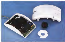
Dettaglio sul mouse e sul suo interno. La pallina è presente e dotata di un rivestimento antiriscaldamento sul piano
